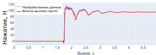
Рис. 2: Изменение нажатия при подъеме токоприемника и касании контактного провода.
