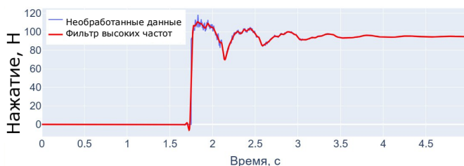
Рис. 2: Изменение нажатия при подъеме токоприемника и касании контактного провода.
